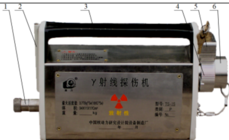
1、源顶鞭 2、轴顶鞭管 3、手把 4、安全联锁装置 5、安全锁 6、端盖
