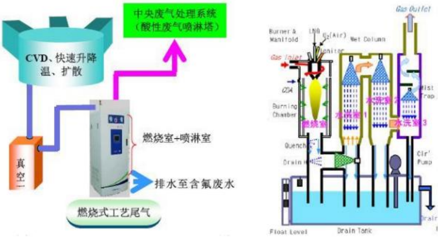
图 4-1 工艺尾气电加热水洗装置处理流程及内部示意图
