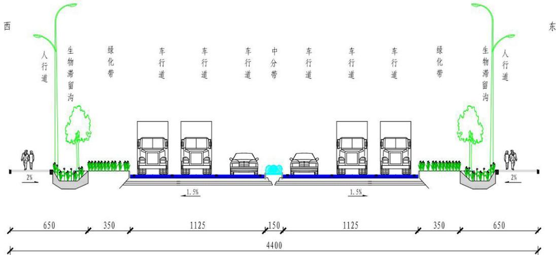
图 2-2 本工程道路标准横断面图
