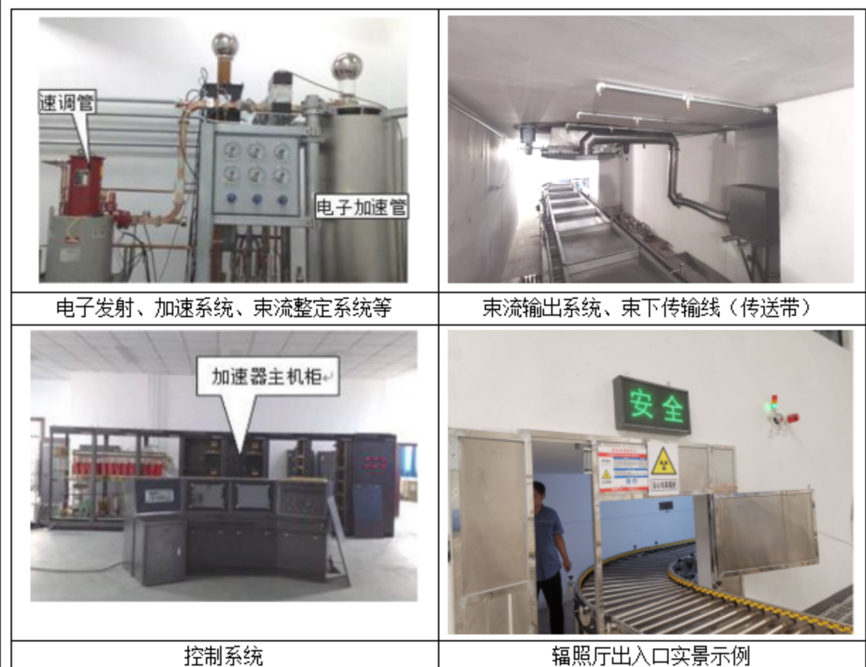
图9-2 本项目电子加速器结构示意图
