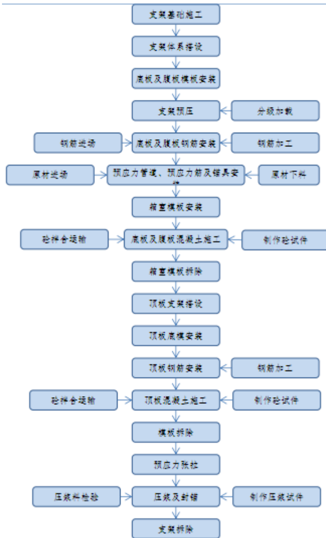
图 2-4-4 桥梁上部结构施工工艺流程图
