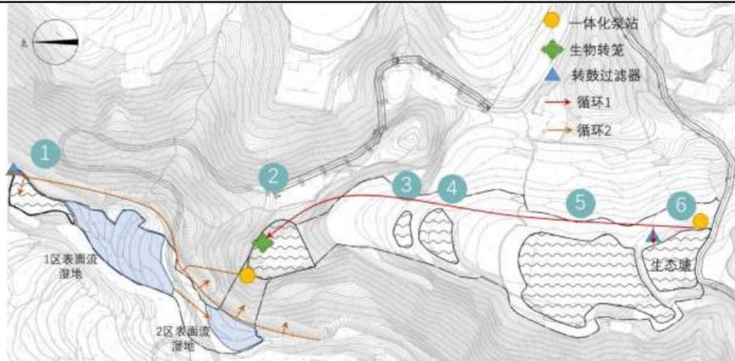
图 2.3-27 水循环系统布置示意图
