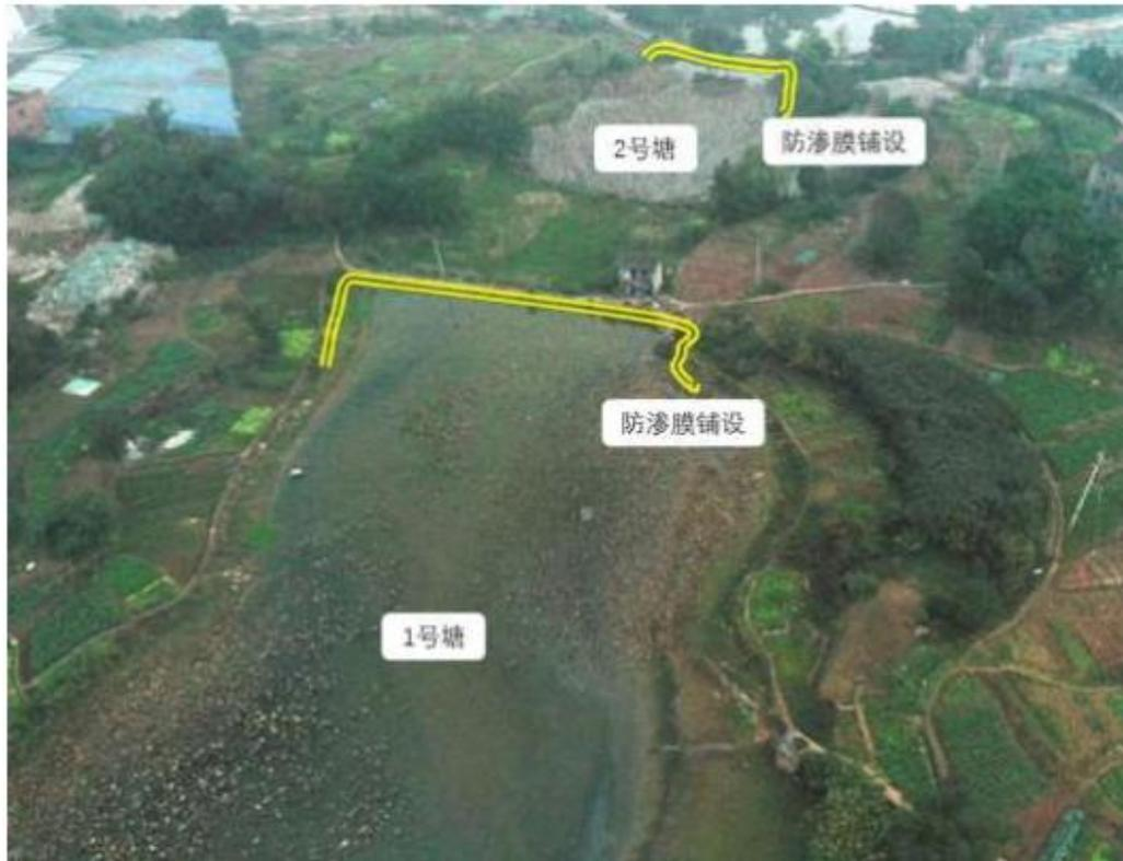
图 2.3-11 张家河沟上游塘体防渗膜铺设平面示意图
