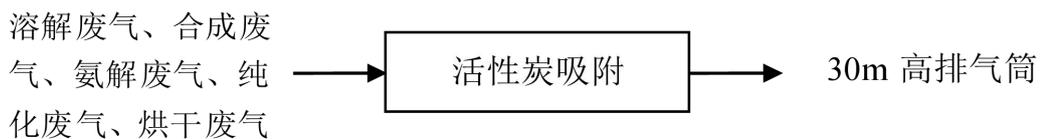
图 2.10.4 废气处理工艺流程图
