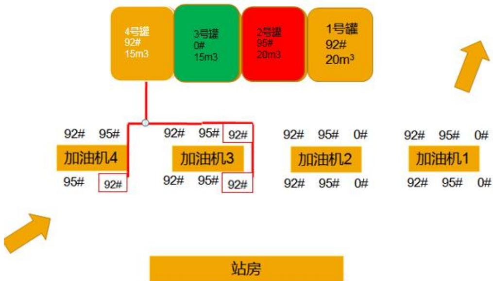
图 2.3-2 改造后加油站油罐区及加油枪布局图
