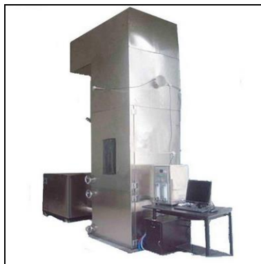
建筑材料难燃性实验炉
