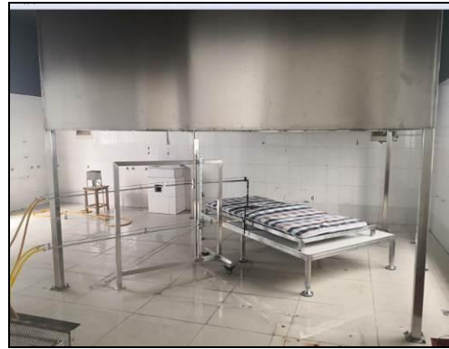
家具大型量热仪-燃烧室
