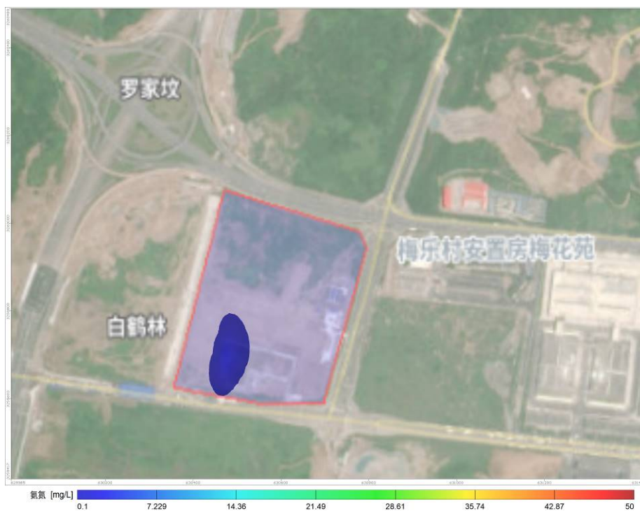
图 5.2.5-24 污水处理站调节池泄漏 3650d 后 \text{NH}_3\text{-N} 污染情况
