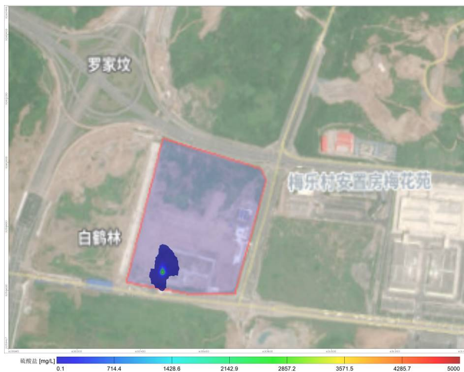
图 5.2.5-34 污水处理站调节池泄漏 365d 后氯化物污染情况
