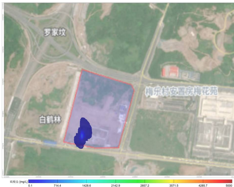
图 5.2.5-29 污水处理站调节池泄漏 1000d 后硫酸盐污染情况
