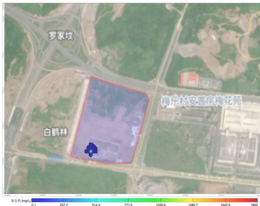
图 5.2.5-33 污水处理站调节池泄漏 100d 后氯化物污染情况
