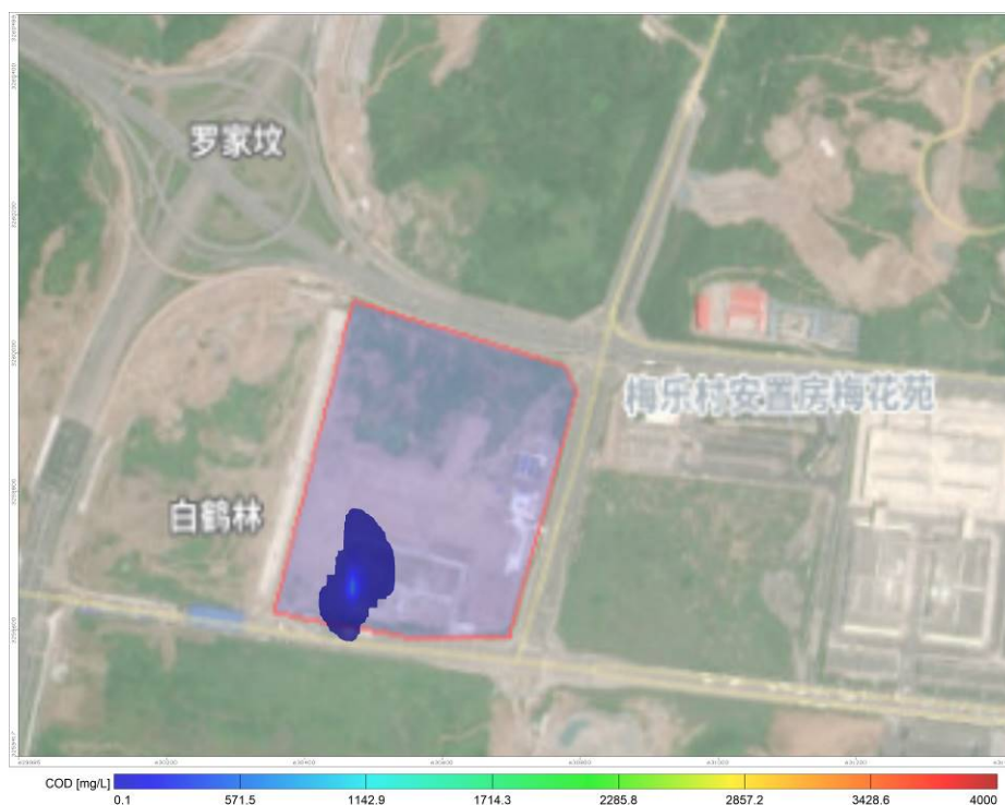
图 5.2.5-17 污水处理站调节池泄漏 1000d 后 COD Mn 污染情况
