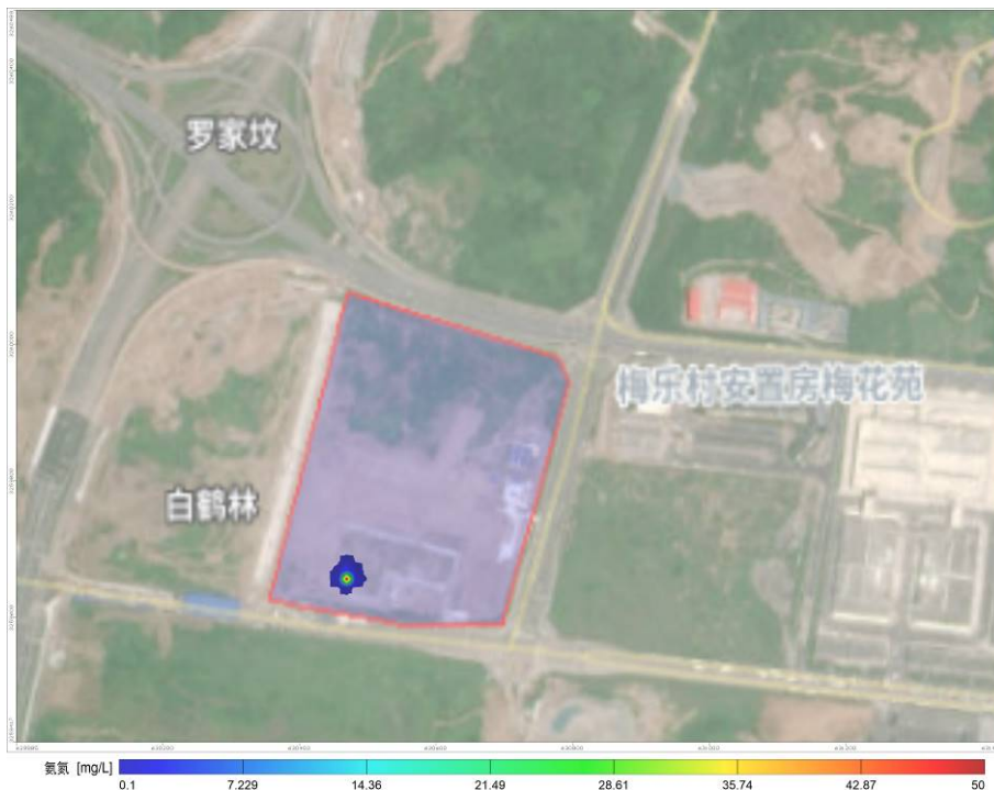
图 5.2.5-21 污水处理站调节池泄漏 100d 后 NH 3 -N 污染情况
