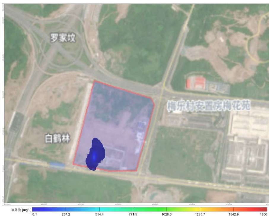
图 5.2.5-35 污水处理站调节池泄漏 1000d 后氯化物污染情况
