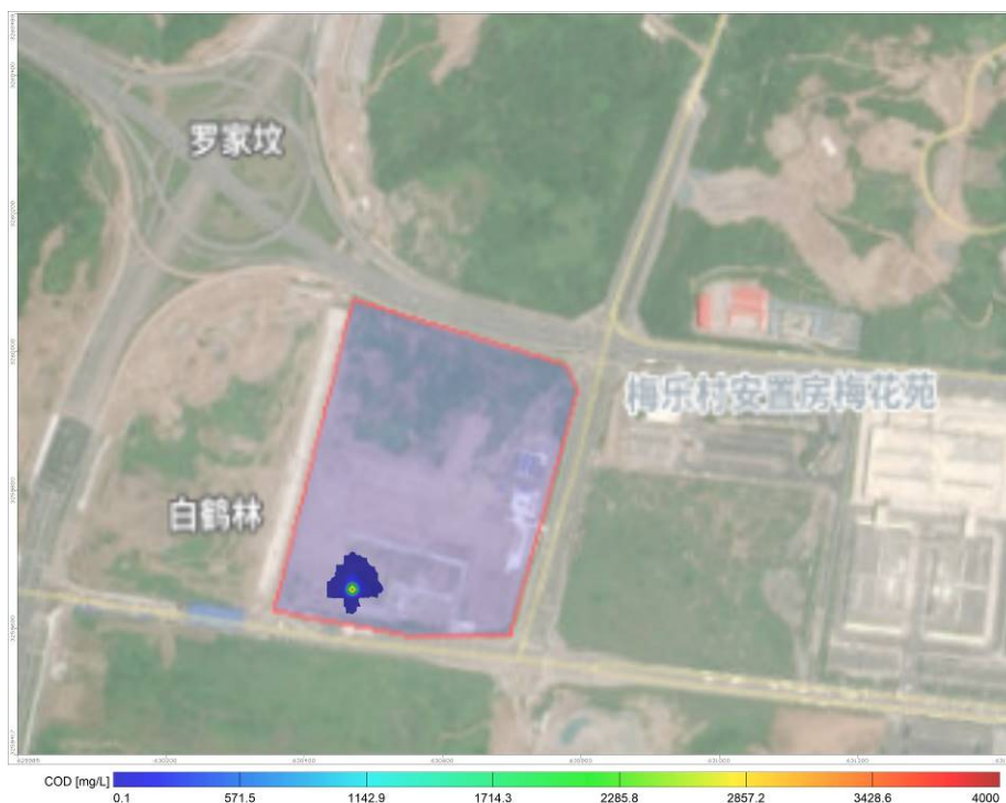
图 5.2.5-15 污水处理站调节池泄漏 100d 后 COD_{Mn} 污染情况
