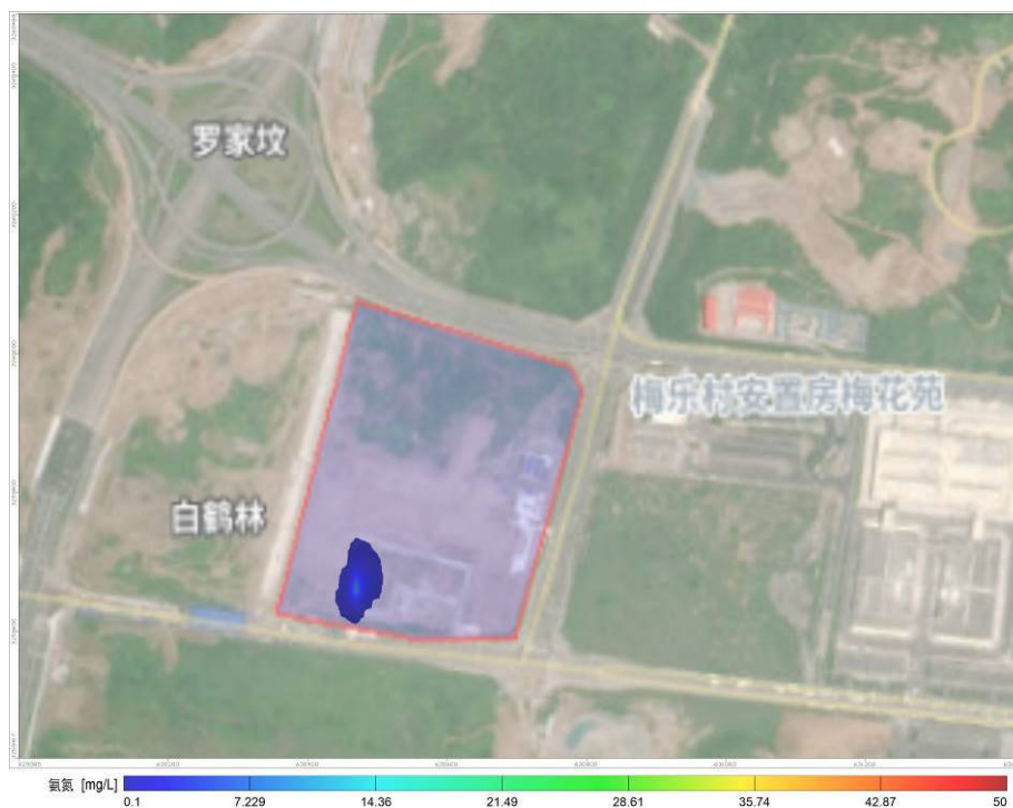
图 5.2.5-23 污水处理站调节池泄漏 1000d 后 NH 3 -N 污染情况
