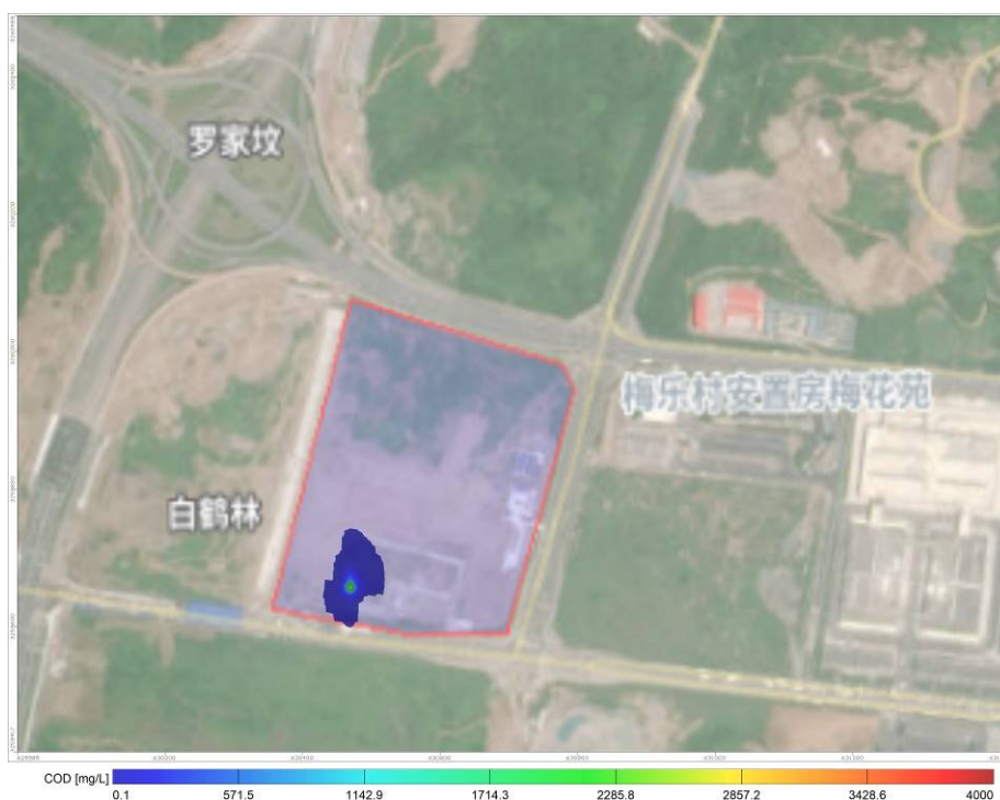
图 5.2.5-16 污水处理站调节池泄漏 365d 后 COD_{Mn} 污染情况
