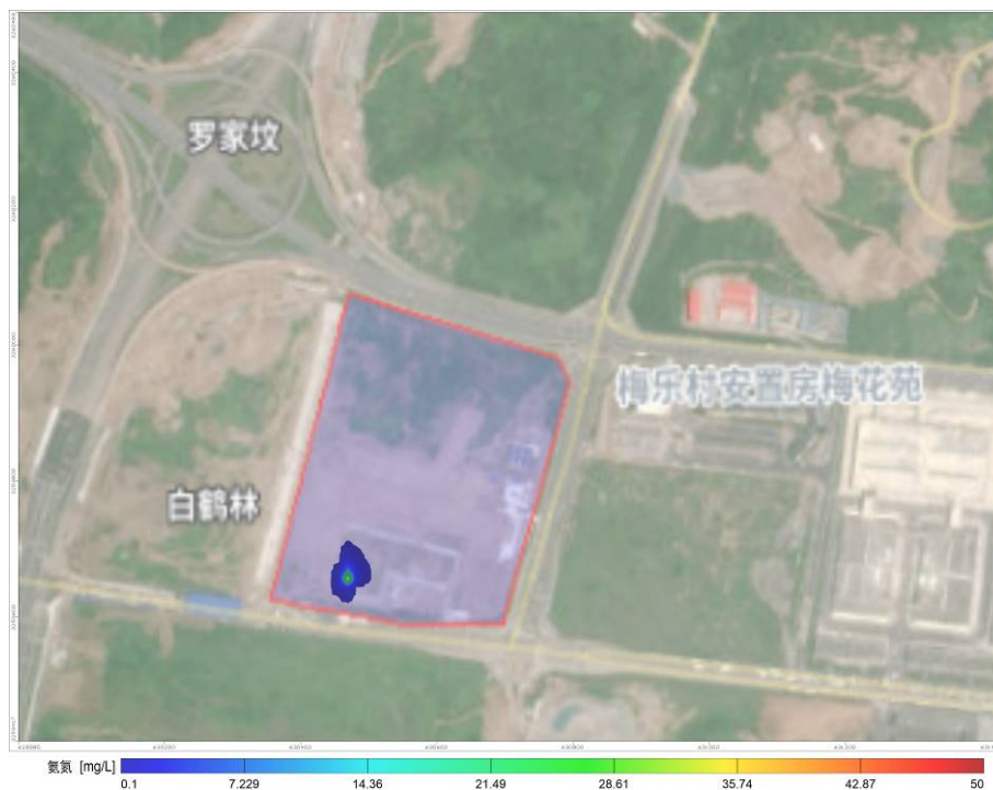
图 5.2.5-22 污水处理站调节池泄漏 365d 后 NH 3 -N 污染情况
