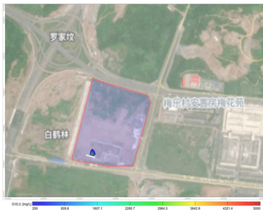
图 5.2.5-28 污水处理站调节池泄漏 365d 后硫酸盐污染情况
