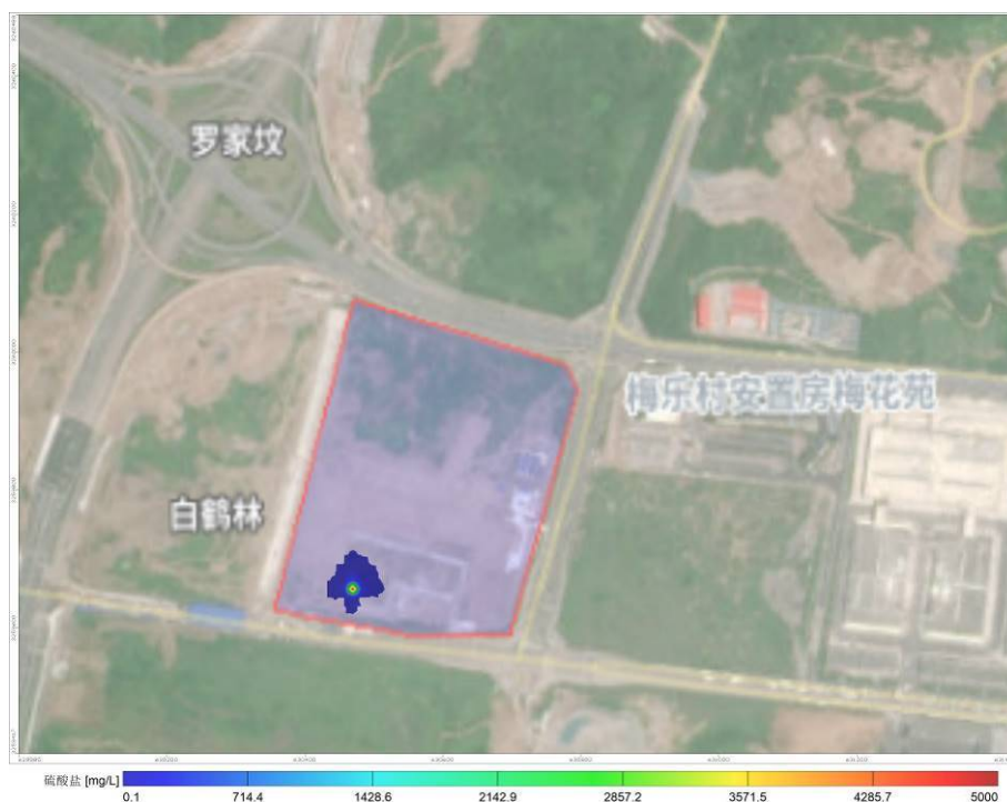
图 5.2.5-27 污水处理站调节池泄漏 100d 后硫酸盐污染情况
