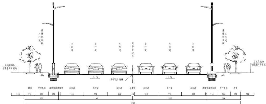
图 2-1 本工程道路标准横断面图
