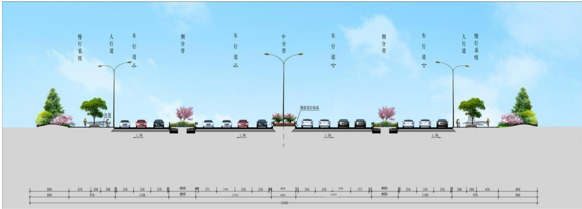
图 2-17 北段道路标准横断面图（中柱立交-西永大道段）
