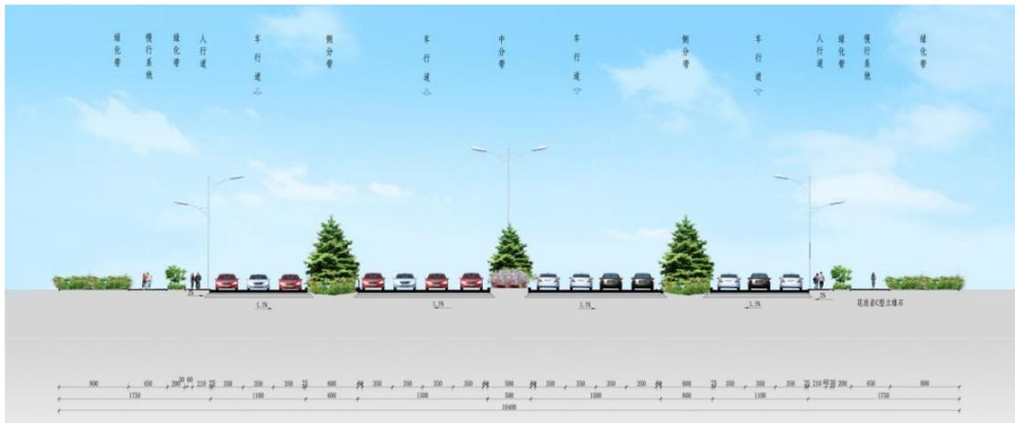
图 2-15 南段道路标准横断面图（古驿路立交至加工区一横线立交段）
