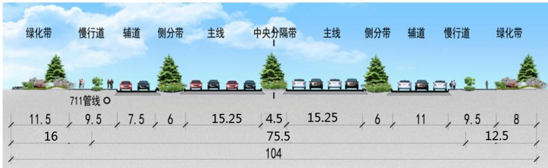
图 2-13 南段道路标准横断面图（石坝立交至农马立交段）
