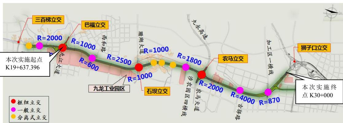
图 2-1 南段工程主线总体平面设计图
